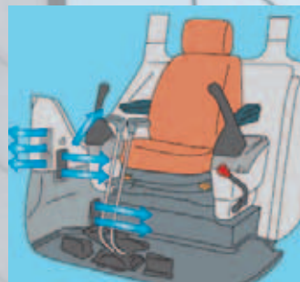
Отопление и кондиционирование
